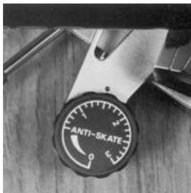
Регулятор компенсатора скатывающей силы SME 309
