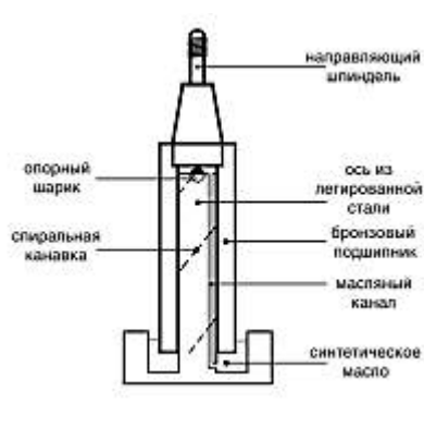
схема подшипника проигрывателей Michell
